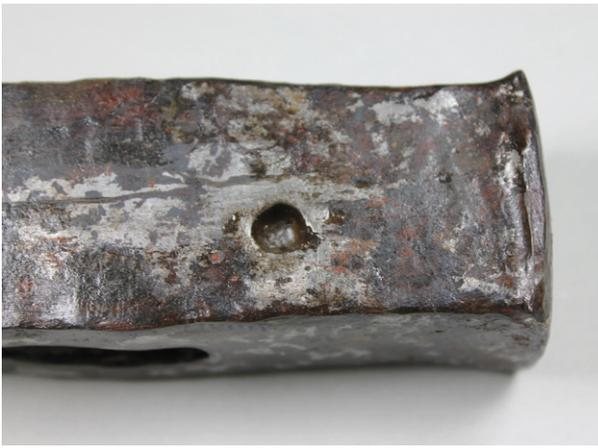
Abb. 1: Freigelegte runde Vertiefung am Setzhammer (Foto: S. Krutter)
