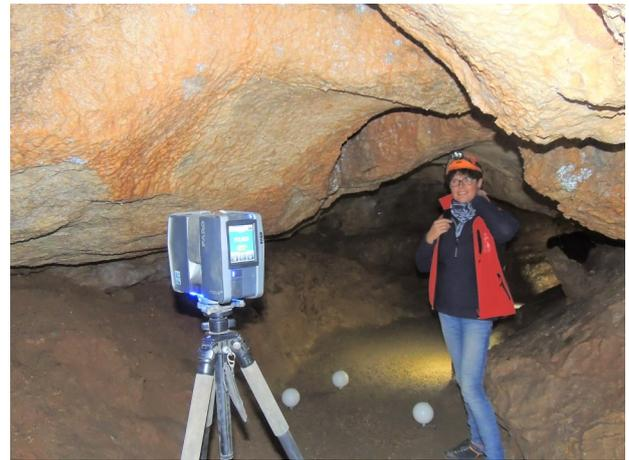
Fig. 4: The FARO 120 in action in the Binghöhle. Note the three reference balls at the floor and the scallops on the ceiling and walls. Photo: S. Kempe. | Abb. 4: Der FARO 120 beim Scannen in der Binghöhle. Beachte drei Referenz-Bälle auf dem Boden und die Fließfacetten an den Wänden. Foto: S. Kempe.
